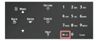
2 Enter «2» «0» «1» using the numeric keypad and then press the «ENTER» button.
