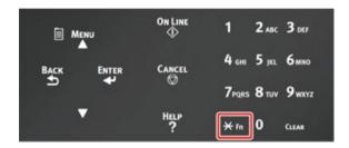
2 Enter «2» «0» «2» using the numeric keypad and then press the «ENTER» button.
