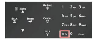
2 Enter «1», «0», «0» using the numeric keypad, check [100] is displayed on the display screen, and press the «ENTER» button.
