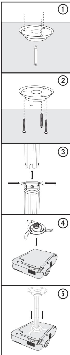
Ostit kattokiinnikkeen projektoriolle. Sen asennus betoni- tai puukattoon tehdään käytämällä mukana seuraavia ruuveja ja tulppia. Jos asennus tehdään muuntyypiseen kattoon tarvitaan muuntyyppiset kiinnitysvälaineet (eivät mukana).
