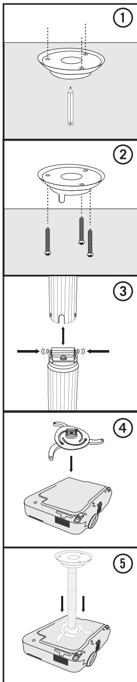
Du har kjøpt et takfeste for en prosjektor. Vennligst bruk de medfølgende skruene og pluggene dersom du monterer på et betong- eller tretak. Monterer du på andre type tak bør du bruke skruene og pluggene som egner seg best for dem (ikke inkludert).
