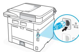
**Nota:** Si su producto admite fax, no conecte por error el cable Ethernet al puerto del teléfono.
