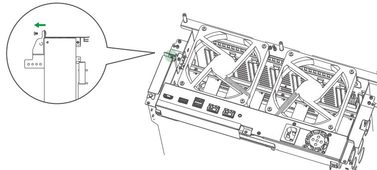
6. Setzen Sie die Karte in den Steckplatz ein und stellen Sie sicher, dass die Karte fest angeschlossen ist. Ziehen Sie dann die Schrauben fest.
