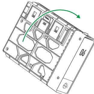
**2. Klammerarm ziehen:** Drücken Sie die Taste mit dem Symbol „Press“, um den Arm zu ziehen.
