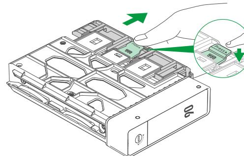
**3. Festplatte installieren:** Legen Sie die Festplatte in den Einschub ein. Bitte stellen Sie sicher, dass die Montagestifte auf dem Einschub mit den Schraubenlöchern an der Festplatte korrekt ausgerichtet sind.
