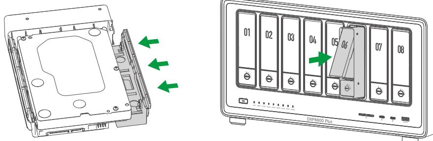
**5. 完成安装:** 将托架装回 NAS 主机内并锁紧。
