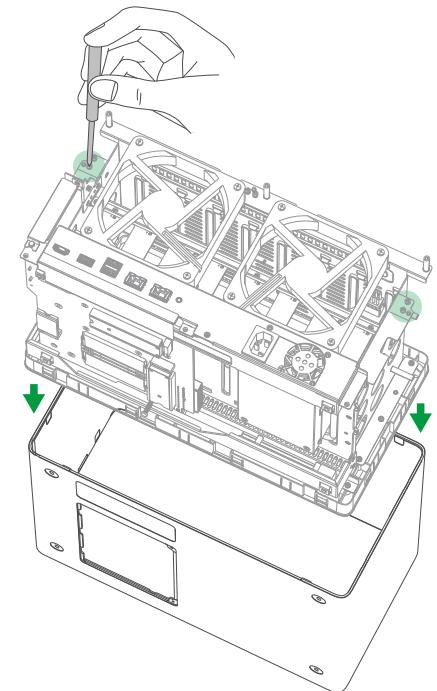
5. Entfernen Sie die Schraube an der vorhandenen Halterung. Entfernen Sie dann die Halterung und bewahren Sie sie auf, falls Sie die PCIe-Erweiterungskarte entfernen und die Halterung wieder anbringen müssen.
