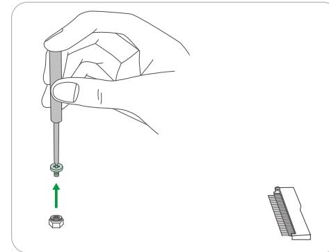
3. Setzen Sie die M.2-Festplatte in der in der Abbildung gezeigten Richtung in den Steckplatz ein, und ziehen Sie dann die Schrauben fest.
