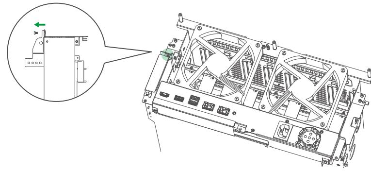
6. 将扩展卡插入 PCIe 插槽，并确保扩展卡的金属接口完全插入插槽，拧紧螺钉。
