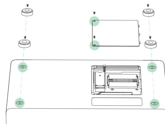
3. Drehen Sie das Gerät auf Rückseite, lösen Sie dann die Schrauben und entfernen Sie den Kühlkörper.
