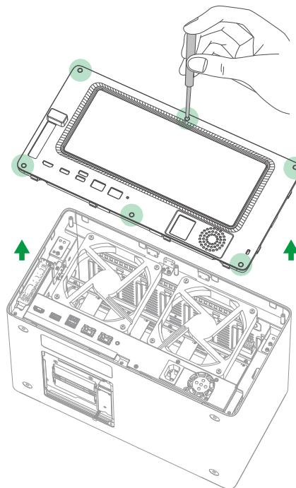
4. Lösen Sie die inneren Schrauben des Geräterahmens und entfernen Sie den gesamten Rahmen.
