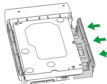
**5. Abschluss der Installation:** Legen Sie den Einschub in die NAS-Haupteinheit ein und befestigen Sie ihn.
