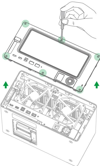
4. 拧开设备机架内部螺钉，取出整个机架。
