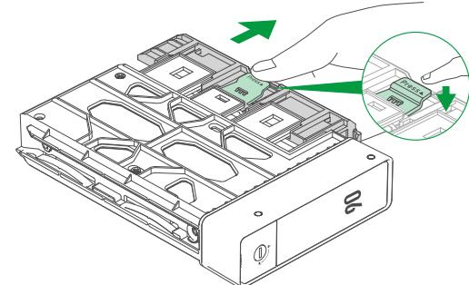
**3. 装入硬盘:** 将硬盘装入托架, 注意固定柱与硬盘的螺丝孔对齐。
