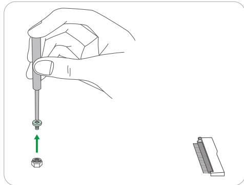
3. 将 M.2 硬盘如图示方向对应插入 M.2 插槽，拧紧螺钉。
