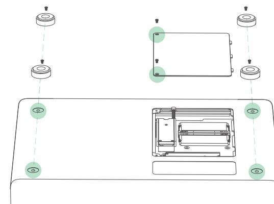
3. 将设备的背面朝上，拧下螺钉并卸下散热网。
