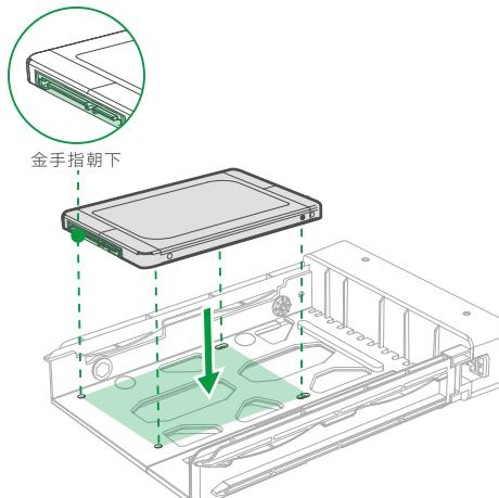
**3. 固定硬盘:** 翻转托架至背面, 装入随附的螺丝钉并拧紧。
