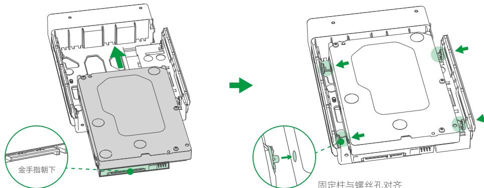
**4. 固定硬盘:** 将夹臂推回原位, 即可将硬盘固定在托架上。
