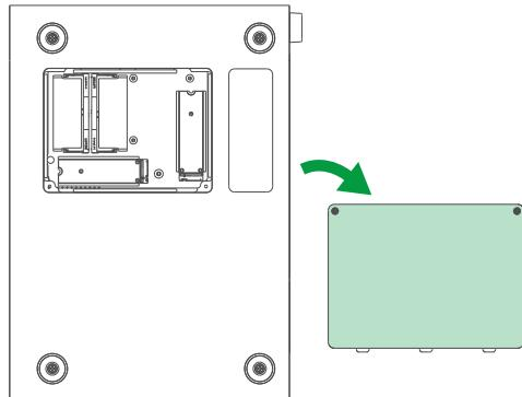
2. Lösen Sie die M.2-Befestigungsschrauben.
