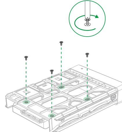
**3. Festplatte sichern:** Drehen Sie den Festplatteneinschub um, setzen Sie die Schrauben ein und ziehen Sie sie fest.
