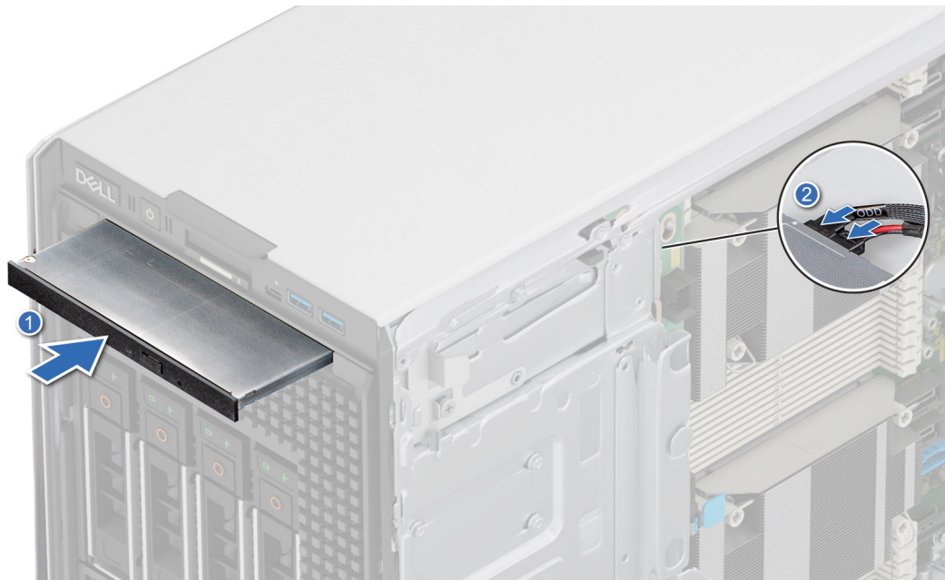
Figure 128. Installation du lecteur optique
