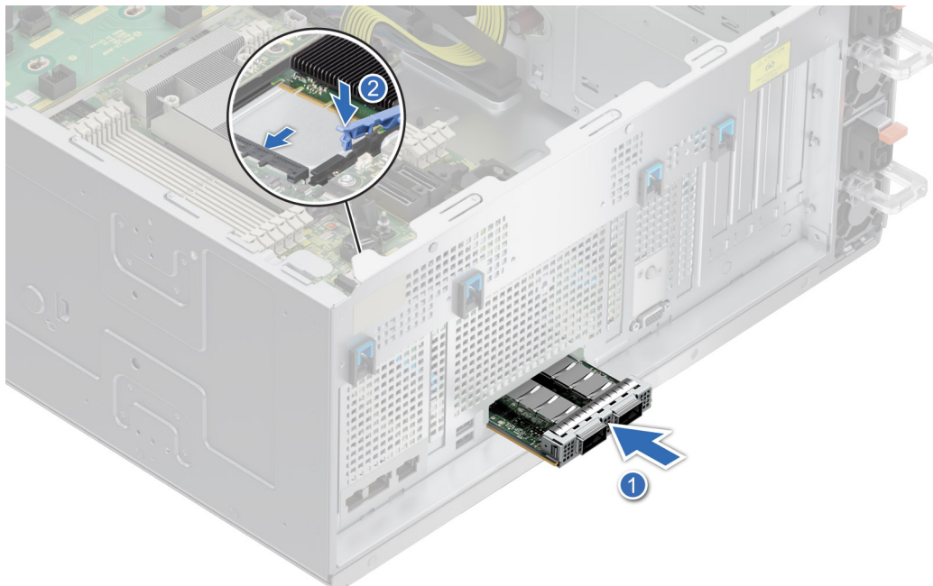
Figure 176. Installation de la carte OCP
