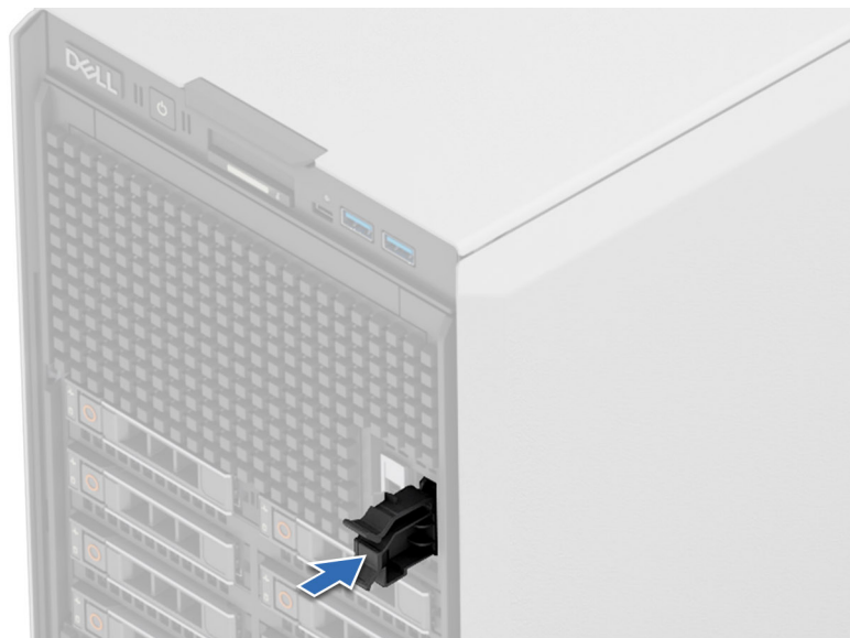
Figure 144. Installation du cache du support de carte BOSS-N1
