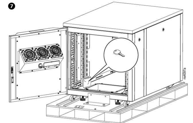
8. Entriegeln und öffnen Sie die Vordertür. Entfernen Sie die beiden (2) Torx-Schrauben T-30, mit denen jede Halterung am Rack befestigt ist. Verwenden Sie einen 13-mm-Steckschlüssel (nicht im Lieferumfang enthalten), um die zwei (2) 10 x 20-Schrauben zu entfernen, mit denen jede Halterung (vorne und hinten) an der Palette befestigt ist.
