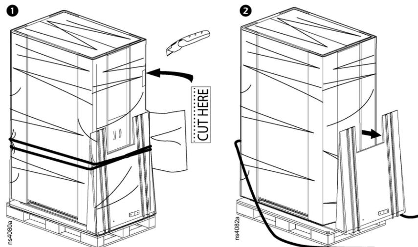
3. Nach dem Entfernen der Kunststoffverpackung können die Schaumstoff-Eckprotektoren entfernt werden.
