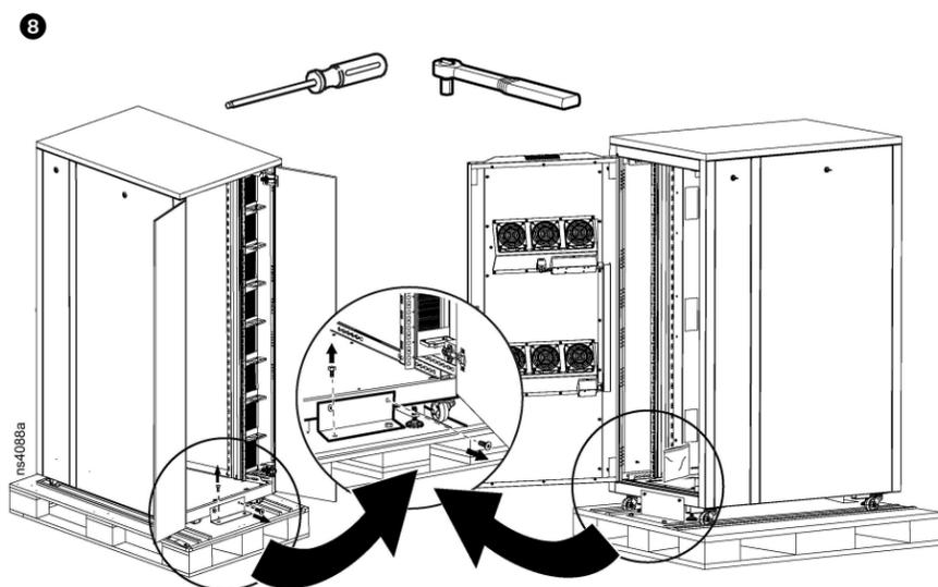
9. Entfernen Sie die Schraube, mit der die Rampehalterung befestigt ist (A), die an der Palette befestigt ist. Entfernen Sie die Schraube, mit der die zweite Rampehalterung befestigt ist (B), die auf der Rampe installiert ist. Zusätzliche Rampebolzen sind auf der Palette und Rampe vorhanden.
