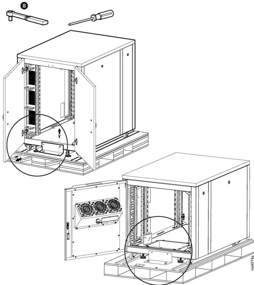
9. Entfernen Sie die Schraube, mit der die Rampenhalterung befestigt ist (A), die an der Palette befestigt ist. Entfernen Sie die Schraube, mit der die zweite Rampenhalterung befestigt ist (B), die auf der Rampe installiert ist. Zusätzliche Rampenbolzen sind auf der Palette und Rampe vorhanden.
