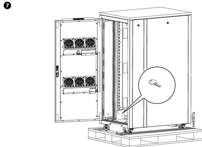
8. Entriegeln und öffnen Sie die Vordertüren. Entfernen Sie die zwei (2) Torx-Schrauben T-30, mit denen jede Halterung (vorne und hinten) am schränk befestigt ist. Entfernen Sie die beiden (2) 10 x 20-Schrauben, mit denen jede Halterung an der Palette befestigt ist, mit einem 13-mm-Steckschlüssel.
