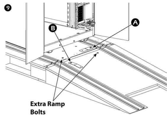
10. Schließen Sie die Türen. Befestigen Sie die Rampe mit den Halterungen und den mitgelieferten Schrauben an der Palette.
