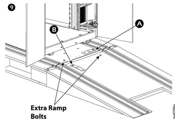
10. Schließen Sie die Türen. Befestigen Sie die Rampenhalterungen mit den mitgelieferten Schrauben an der Rampe und Palette.
