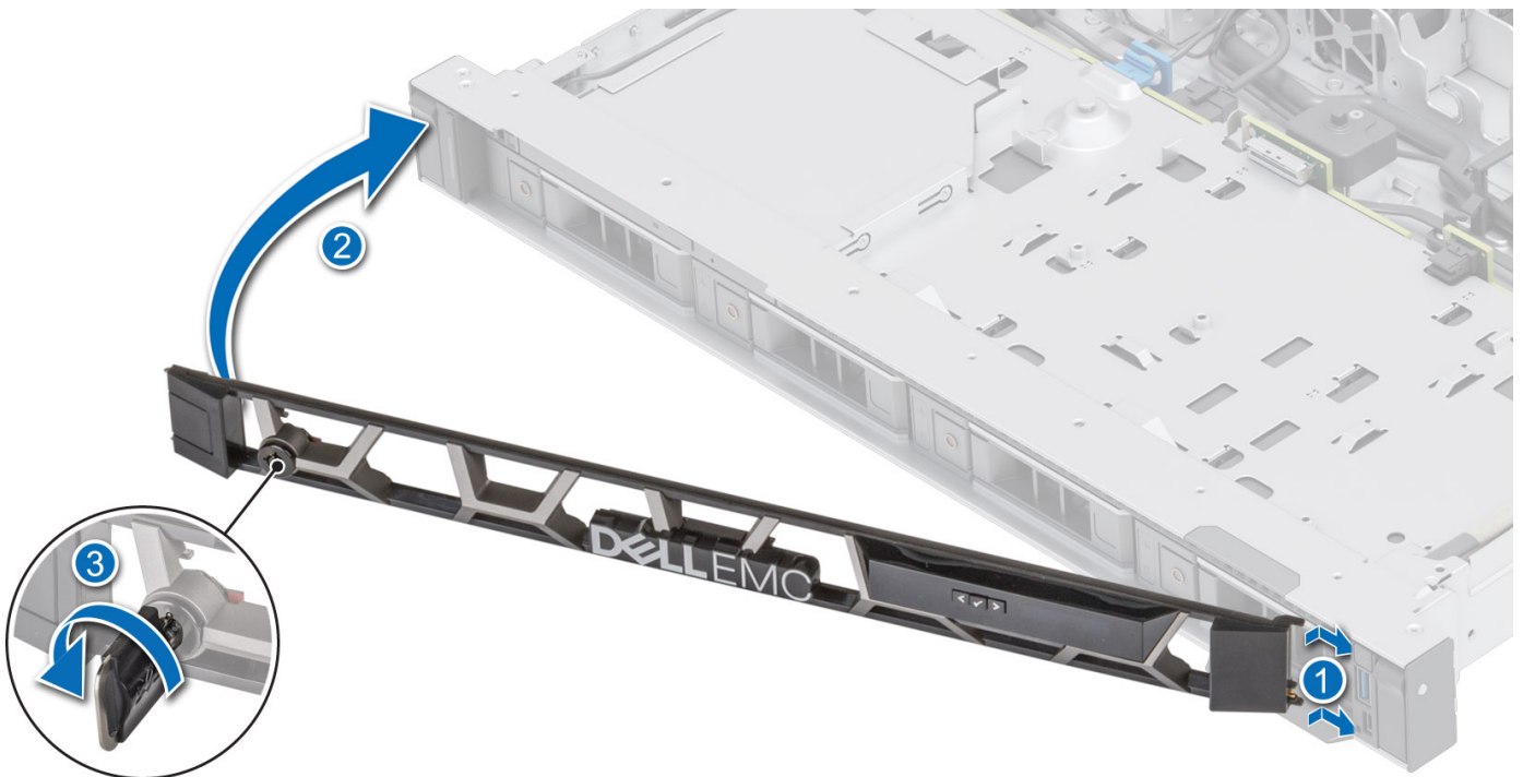
Figure 12. Installation du panneau avant
